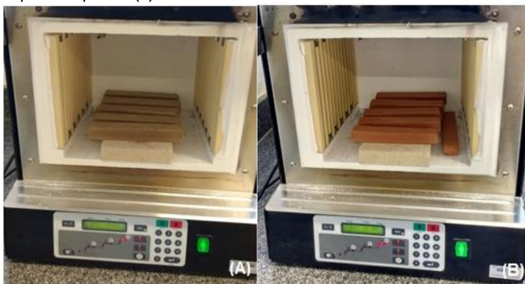
Figura 8 - Forno Mufla VULCAN 3-550PD contendo o material antes (a) e depois da queima (b).
