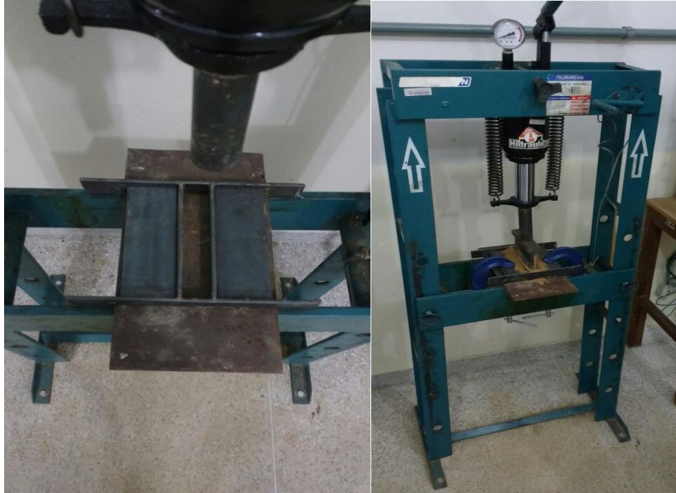
Figura 7 - Fôrma (a) e prensa (b) utilizadas na conformação.
